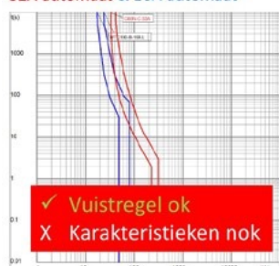
32A automaat & 16A automaat
